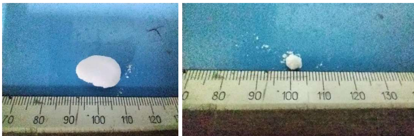
Рисунок 23 – Мікрофотографії частинок вихідних фторполімерів: а – політетрафторетилену, б - кополімер тетрафторетилену з етиленом
