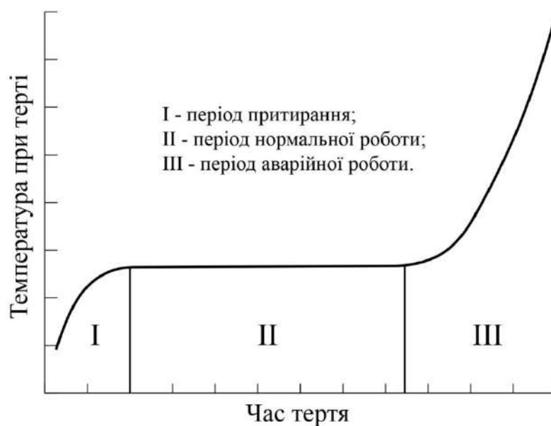
Рисунок 47 – Залежність температури при терті від часу тертя [141]
