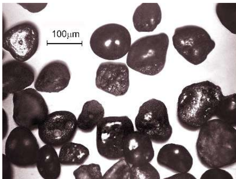
Рис. 3.1. Зерна Самотканського ільменітового концентрату. Carl Zeiss Jena NU-Microscope
